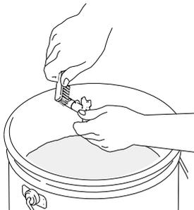
4. Выдуйте остатки материала из наконечника, подав воздух под давлением через шланг. **ПРИМЕЧАНИЕ.** При визуальном осмотре очищенного наконечника его отверстие должно хорошо просвечиваться.
