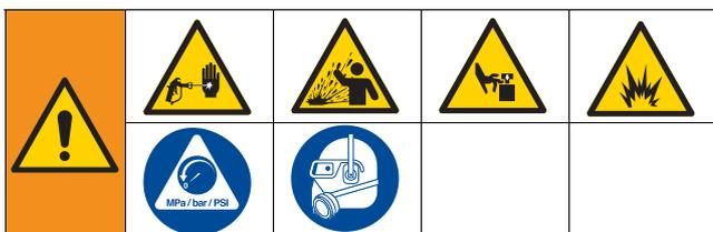
Данное оборудование будет оставаться под давлением до тех пор, пока давление не будет снято вручную. Во избежание получения серьезной травмы от жидкости под давлением (например, в результате инъекции под кожу, разбрызгивания жидкости и от движущихся деталей), после завершения распыления и перед чисткой, проверкой либо обслуживанием оборудования выполняйте процедуру снятия давления.
